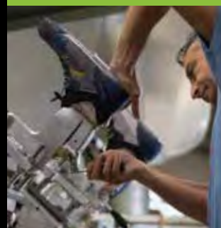
7 INIEZIONE SUOLA Sole injection / Einspritzen der Sohle
